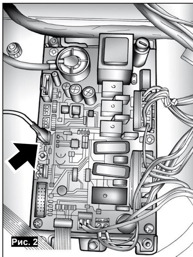
6) Подключите прибор к сети. Включите главный переключатель прибора, чтобы начать программирование. Во время передачи данных на загрузчике мигает зеленый индикатор. По завершении передачи данных зеленый индикатор прекращает мигать и запускается панель управления прибором.
