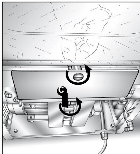
6) Вытащите газовую пружину (Рис. 7). Установите новую пружину и закрепите ее на нижнем штифте скольжения D.
